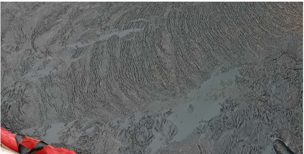
Kuva 2. Vähärikkisen laivapolttoaineen ominaisuudet, erityisesti jäähmettyminen jo suhteellisen korkeissa lämpötiloissa, asettavat haasteita sen keräämiselle. Kuva Xamkin öljynkeräystesteistä keväältä 2025. (kuva: Manu Kettunen).
