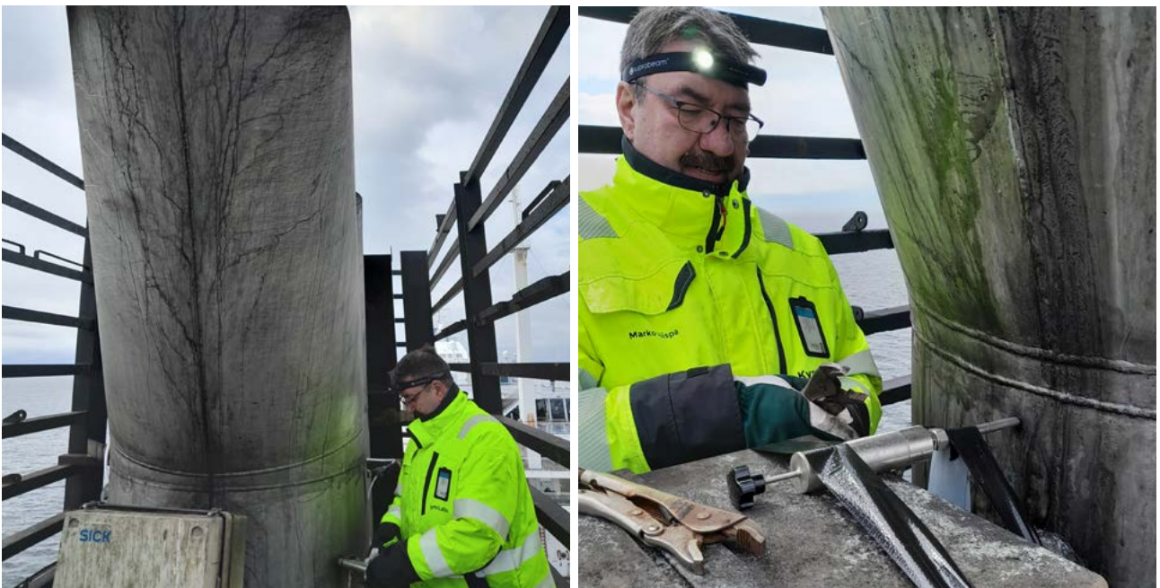
Kuva 1. Päästömittaukset suoritetaan yleensä aluksen korsteenista tätä tarkoitusta varten tehdystä mittausyhteestä. Päästömittaussondin asentaminen on suoritettava tarkasti. (kuvat: Elias Altarriba)
